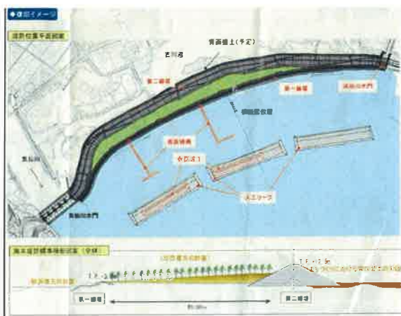
図 9.1 復旧計画 【岩手県資料より】 横断面図に見られるように海に対して緩い傾斜の構造となっている。また、第一線堤の外側には砂浜の復元を目指している。
