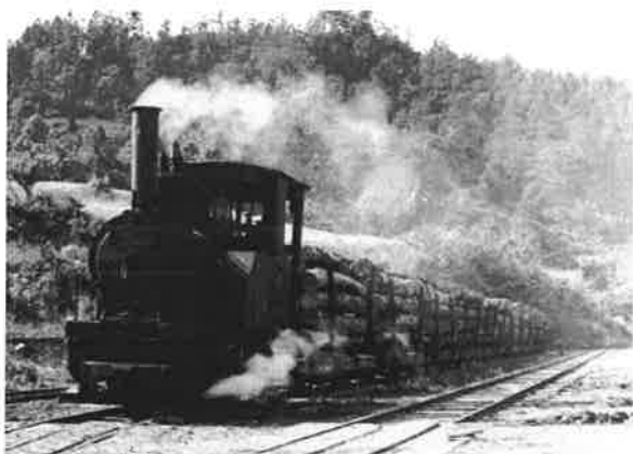
写真2 機関車が台車を牽引する森林鉄道
